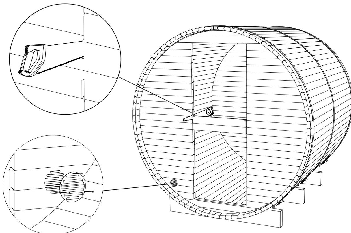
**STEP 13:** .Schraubenlöcher vorbohren. Verbinden Sie beide Teile mit 5.0x120 (S4) Schrauben.
