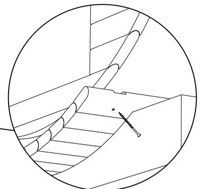
**STEP 5:** Platzieren Sie das Rückwandteil (V) in die Bretternut. Stellen Sie sicher, dass das Teil zentriert, ausgerichtet und komplett in der Nut ist. Fixieren mit Schrauben 5.0 x 120 (S4) am letzten Seitenbrett auf beiden Seiten.
