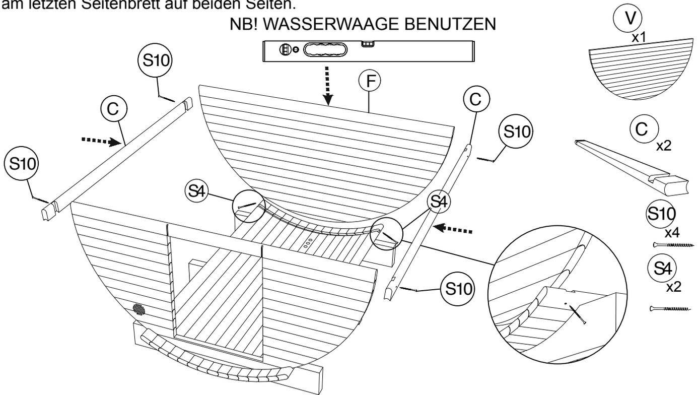
**STEP 6:** Seitenbretter (C) rechts+links montieren. Gummihammer benutzen um die Bretter dicht an das untere Brett zu bekommen. Mit Schrauben 4.0x60 (S10) fixieren. Auf der linken Seite 1 Brett mehr als rechts montieren.
