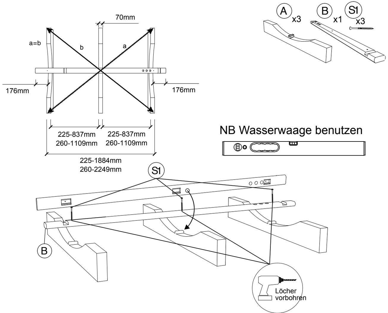
**STEP 2: Löcher vorbohren bevor Sie die Bretter anschrauben.** Legen Sie 6 (R190) resp 7 (R225) Seitenbretter (C) links + rechts neben das Basisbrett (B) und fixieren Sie mit Schrauben 5.0x100 SS (S1). Stellen Sie sicher, dass alle Bretter gut in der Nut im nächsten Brett liegen. Gummihammer benutzen.
