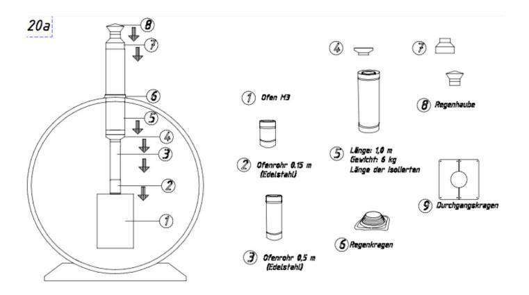
Der Ofen wird It. Beschreibung des Ofenherstellers und der gezeigten Abbildung montiert. Auf den Holzofen werden die nummerierten Artikel in der Reihenfolge, wie auf dem Bild angezeigt, montiert.
