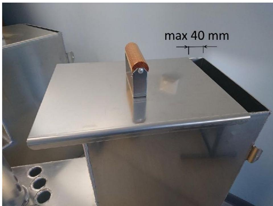
Bild 4. Max. Deckelöffnung während des Betriebs.
