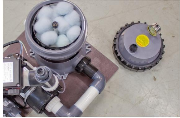
Sie die Ventile (rote Pfeile), schrauben Sie den Filterkanister auf und lassen Sie das Wasser ablaufen.
