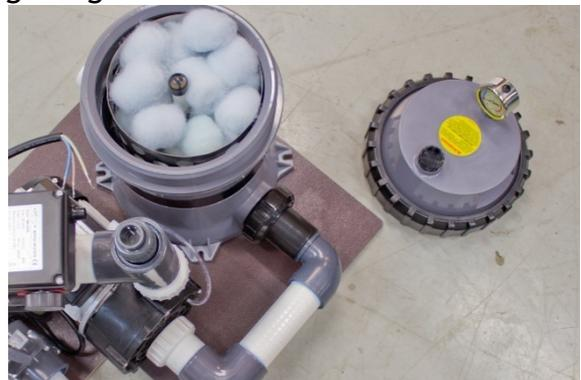
Sie das Filtermaterial ein paar Stunden einweichen, dann drücken Sie das schmutzige Wasser. Wechseln Sie das Wasser und wiederholen Sie den Vorgang so lange, bis kein schmutziges Wasser mehr sichtbar ist. Danach retournieren Sie das Filtermaterial in den Kanister.
