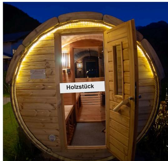
Die außen angebrachten runden Blenden an den Stirnseiten müssen an den Stößen einen Spielraum von ca. 5 mm aufweisen. Bitte kontrollieren Sie dieses beim Nachspannen. Es kann erforderlich sein, dass die Blenden bei extremen Spannvorgängen gelöst werden müssen.
