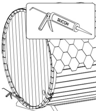
**Die Rundungen an der Front- und Rückseite sind mit AUSSENSILIKON zu silikonieren.**
