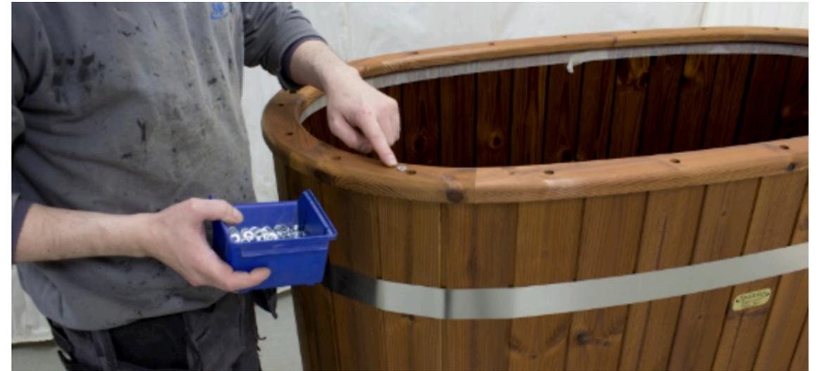
Bohren Sie 3 mm vor und legen Sie zuerst Unterlegscheiben in die Löcher.
