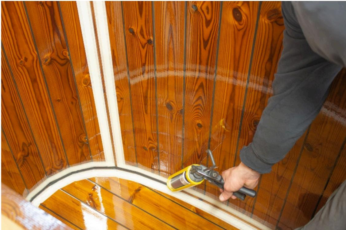
Dichtmittel in der unteren Naht auftragen.
