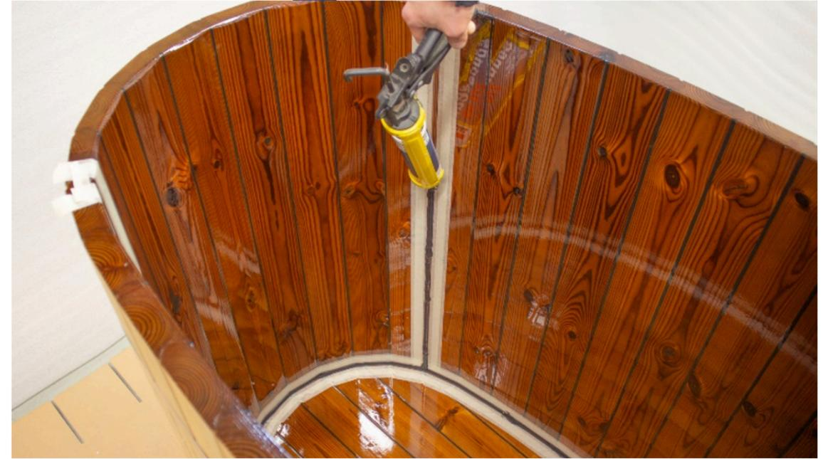
Tragen Sie Dichtmittel auf die Seitenmodulnähte auf.
