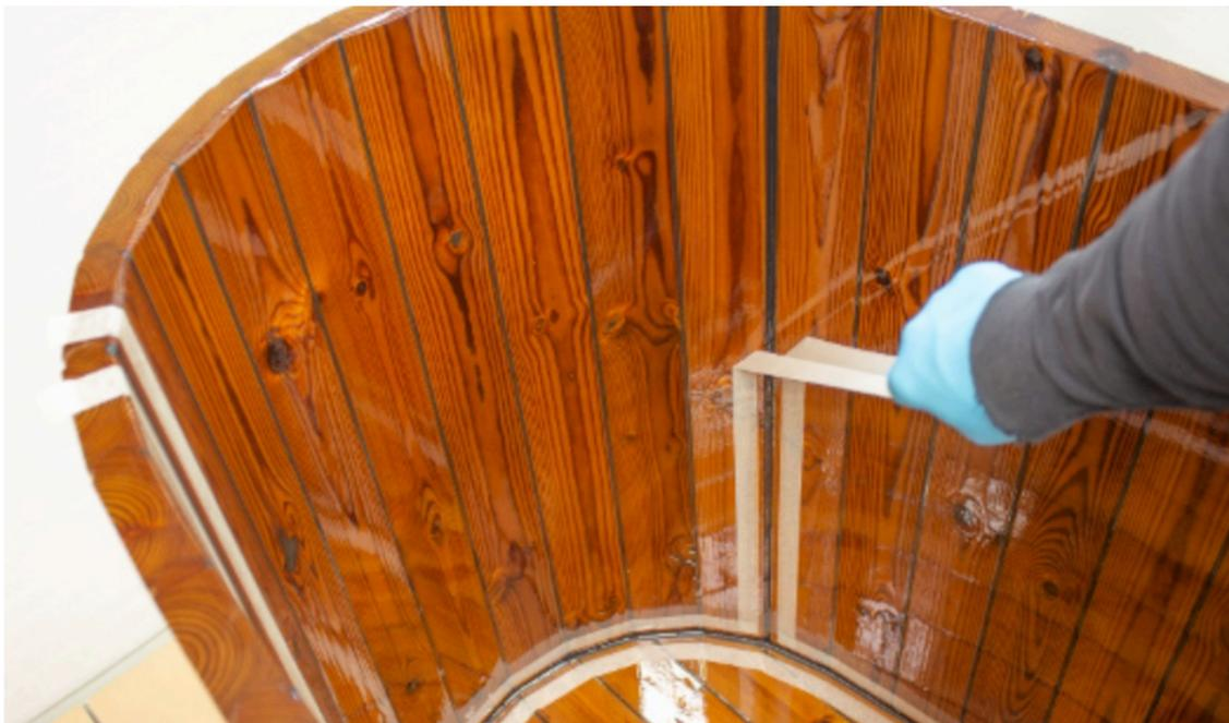
Nach 24-stündigem Trocknen wird eine zweite Schicht in gleicher Weise aufgetragen und das Abdeckband entfernt.
