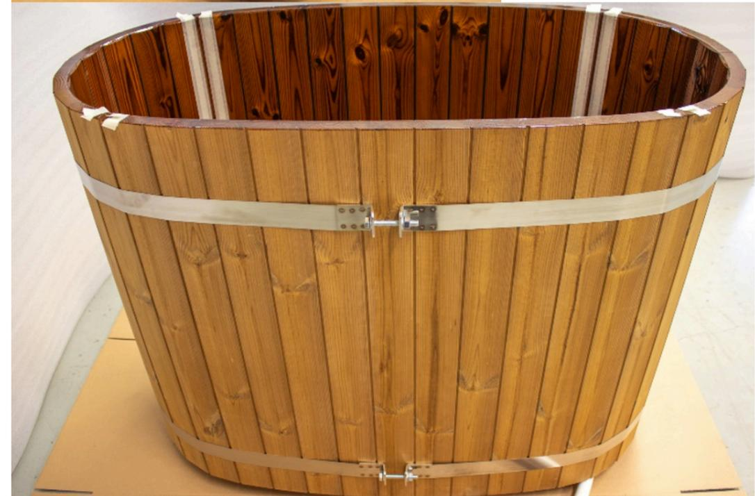
Legen Sie die Edelstahlbänder auf die Nägel und ziehen Sie die Schrauben fest, bis der Abstand zwischen ihnen etwa 40 mm beträgt. Gehen Sie bei angezogener Schraube um die Wanne herum und klopfen Sie mit einem Gummihammer auf die Seiten, um die Module so auszurichten, dass die Bodennaht rundum gleich breit ist.
