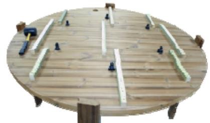
**Die Luftventile werden in den Fassboden geschraubt.**
