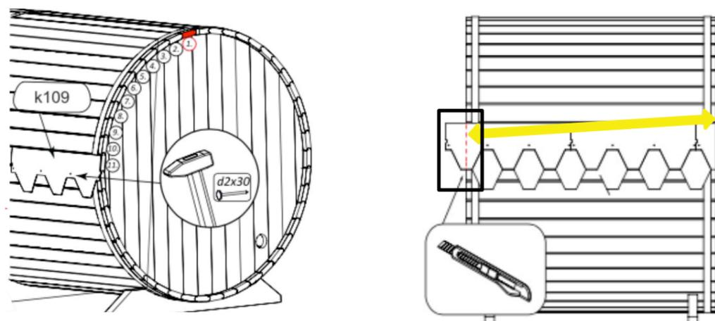
Dachschindeln nicht zu sehr überlappen lassen, sonst sind es zu wenige und werden oben auf dem Dach fehlen. Überstände an den Enden abschneiden und in der darauf folgenden Reihe wieder einfügen.
