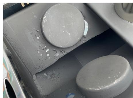
Langsam einheizen und nicht mit Druck. Der Lack muss sich langsam einbrennen. Sollte die Temperatur zu hoch zu sein kann ein Ablösen des Lacks die Folge sein - siehe Foto links
