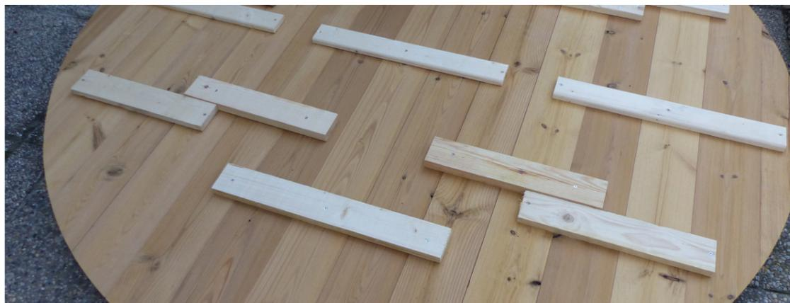
**Die überschüssigen Holzbretter aus der Palette werden zur Verbindung der Rückwand benötigt.**
